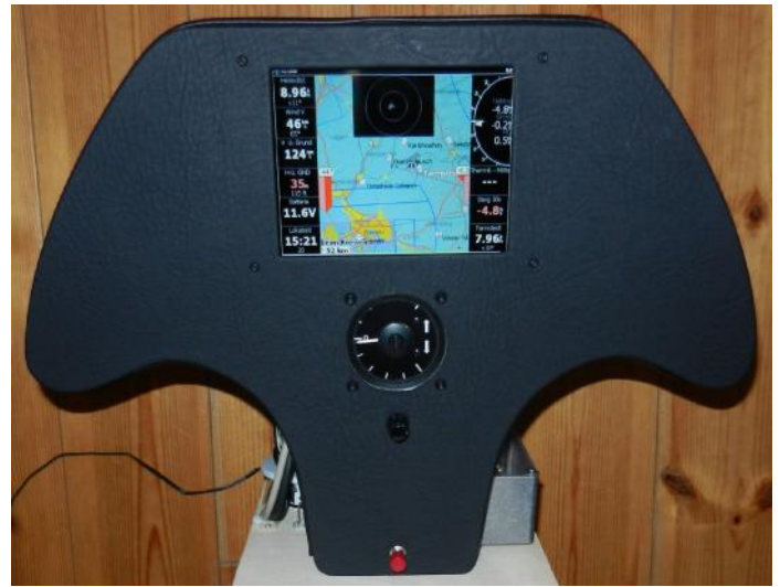
... der Demonstrator mit IPX + 6,5er Display + Sensorbox zum Spielen und weiterentwickeln ...
