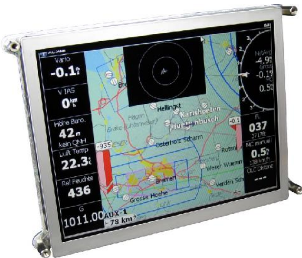
... mit vier Stehbolzen wird der IPX von hinten an I-Brett geschraubt ...
